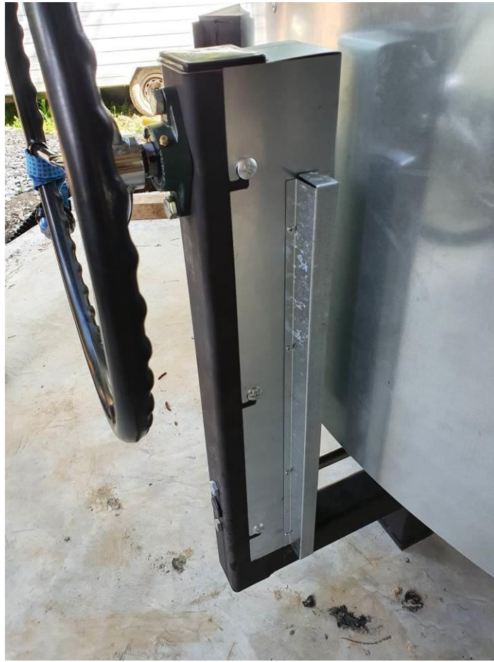
Fixation des carters, installation des cabochons plastiques.
